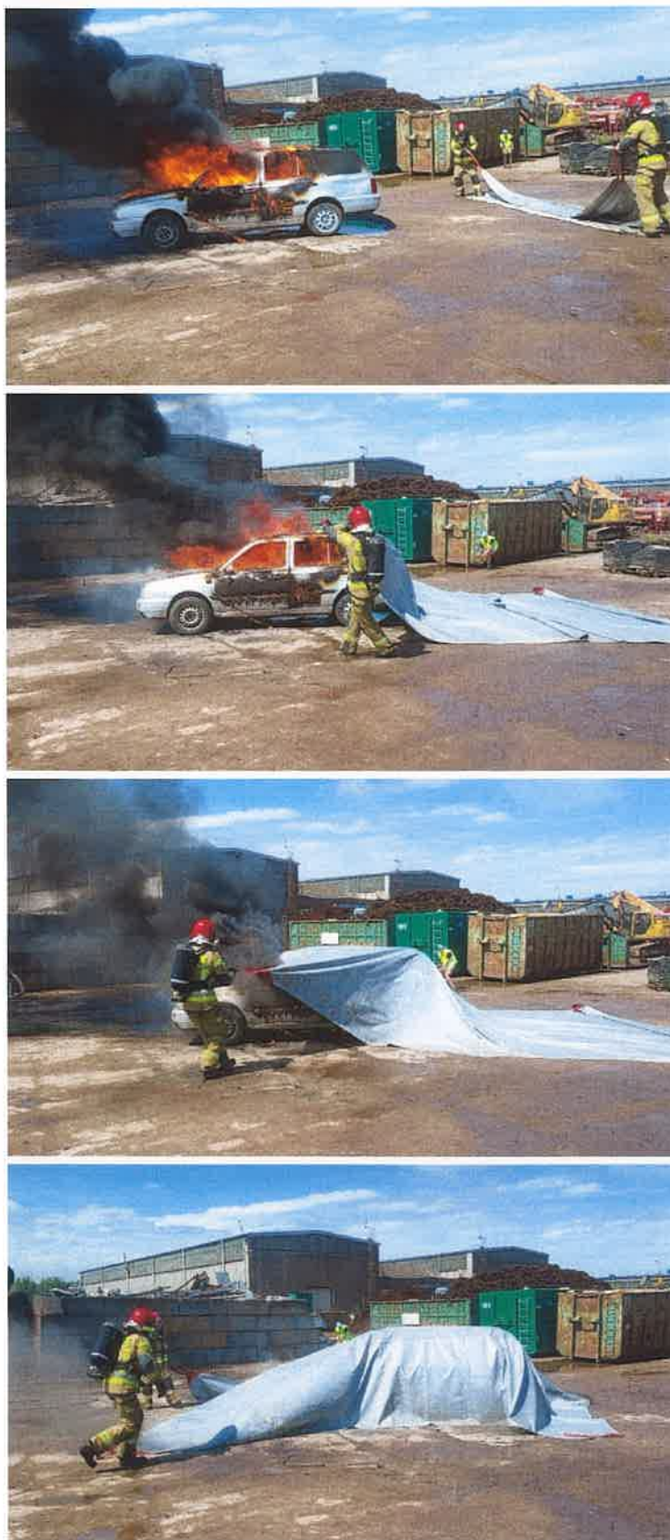
Fot. 26 – 29. Nakładanie płachty typu PG-001 na płonący pojazd Źródło: CNBOP-PIB.
